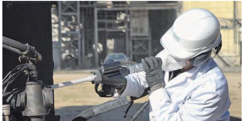
El hielo seco se proyecta a alta presión en pequeñas partículas compactadas denominadas pellets
